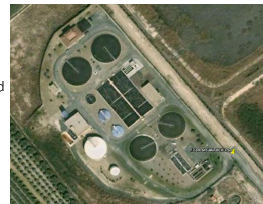
EDAR ALCANTARILLA: Uds: 1 V:3.323 m 3 , TRh:33 días, 0,6 kg MV/m 3 .d
