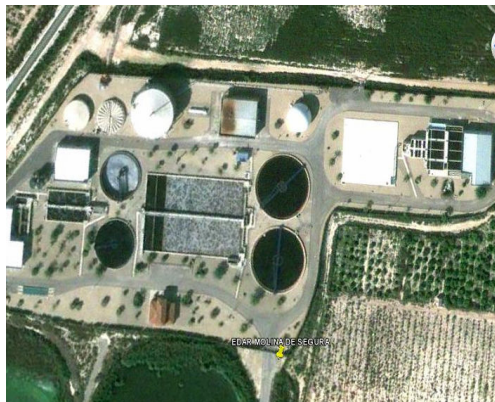
EDAR MOLINA DE SEGURA: Uds: 1 V:7.612 m 3 , TRh:59 días, 0,8 kg MV/m 3 .d
