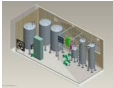
Planta containerizada de purificación de biocombustibles
